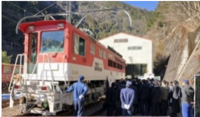
■市代検車庫 アプトいちしろにある日本で唯一のアプト式勾配区間専用電気機関車ED90の検車庫。
